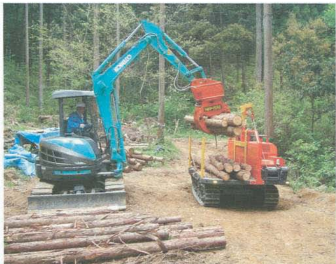
↑間伐した木材を林内運搬車で山のふもとまで運ぶ。集積所で、木材つかみ機を使い降ろす様子(東京都青梅市)。写真提供=株森のエネルギー研究所
