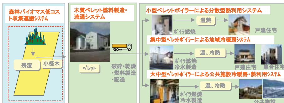
図2 NEDO バイオマス地域システム化実験事業におけるペレット系システムの概要
