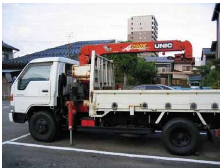
2t 小型移動式クレーン車（積載量 2t）
