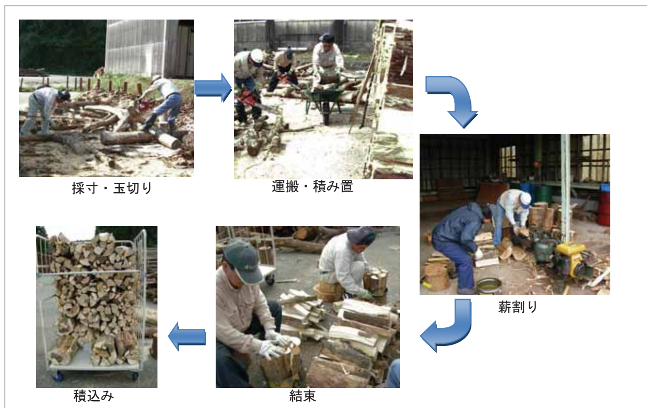
図 4.1.1 薪割り生産の工程図（結束あり）
